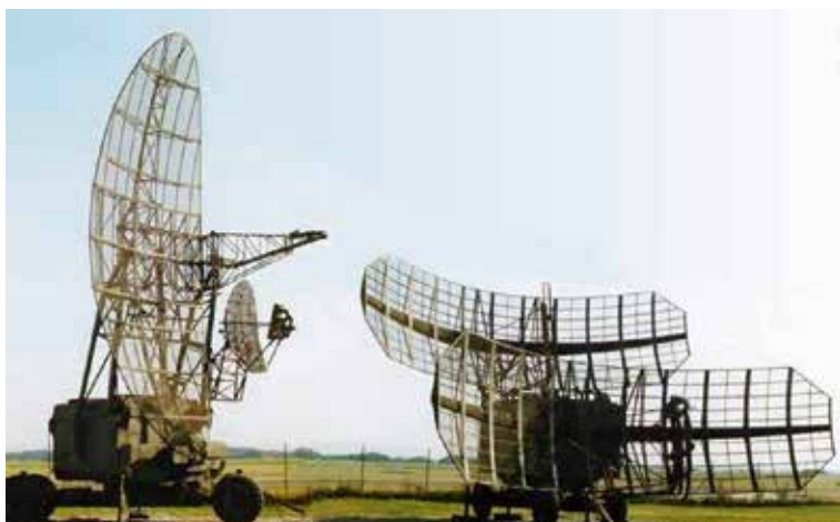
Von der NVA übernommene Radargeräte vom Typ PRW13 und P37
