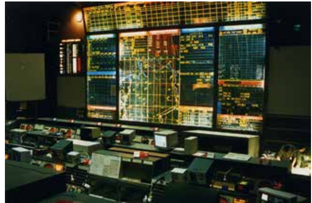
Die Operationszentrale des CRC Loneship im Bunker Erich. Hier fließen sämtliche Informationen zur Luftlage zusammen, Kampfflugzeuge werden mittels Radar und Funk geführt.
