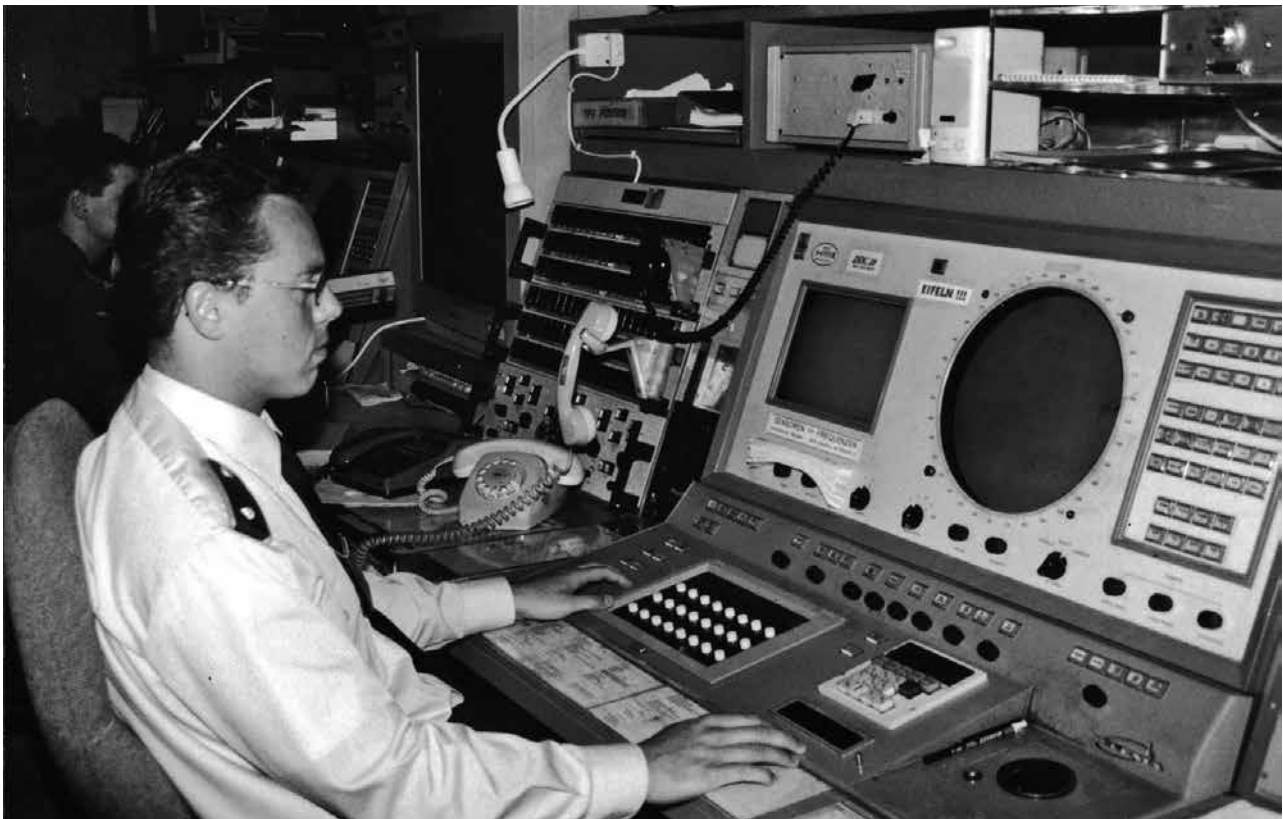
Der NADGE-Arbeitsplatz des Luftlageoffiziers
